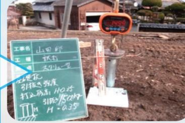
引き抜き強度検査
